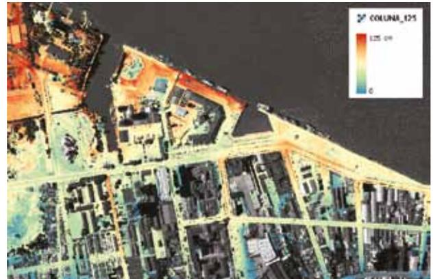
**Figura 18.** Para uma cota de 1,25 metro de elevação do nível do estuário (sendo zero o nível da pedra do cais do CCMAR), as cores da imagem, conforme a legenda, indicam a altura da lâmina d'água nas ruas da cidade.
