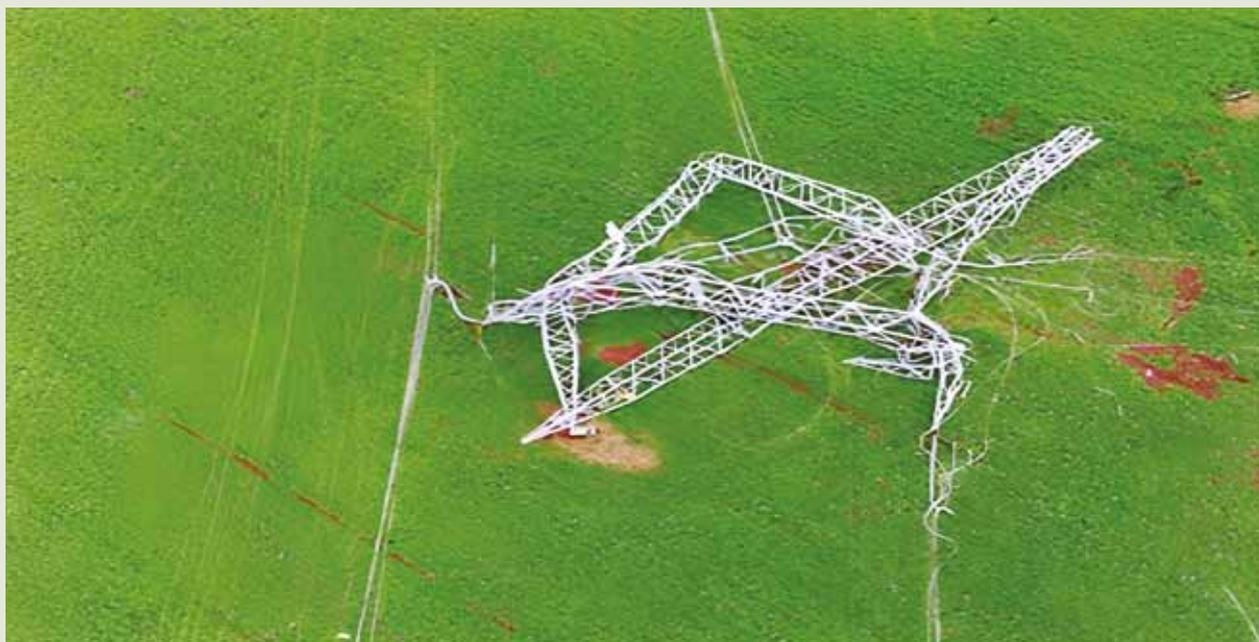
Figura 1. Ilustração dos danos na linha de transmissão da Ceee-Equatorial. Fonte: Eletrosul.
