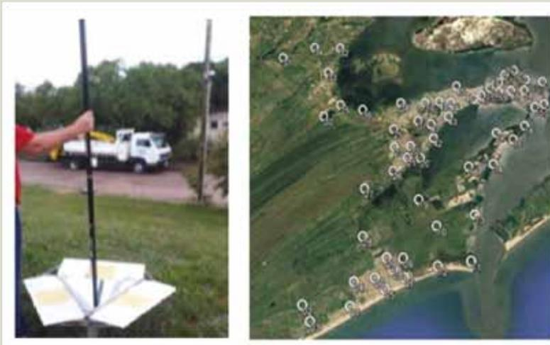
◀ Figura 5. Os refletores laser implantados, e a disposição dos pontos sobre o território de Rio Grande utilizados para composição de um modelo de correção geoidal local.
