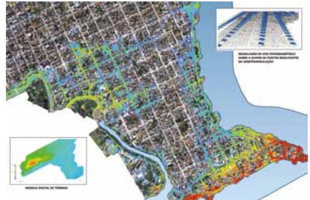
**Figura 4.** No alto, a modelagem de voo fotogramétrico sobre a nuvem de pontos resultantes da aerotriangulação; abaixo, o Modelo Digital de Terreno (MDT) derivado; e ao centro o ortofotomosaico da área, com resolução final de 5 cm para a cidade de São Lourenço do Sul, obtido pela equipe da FURG.
