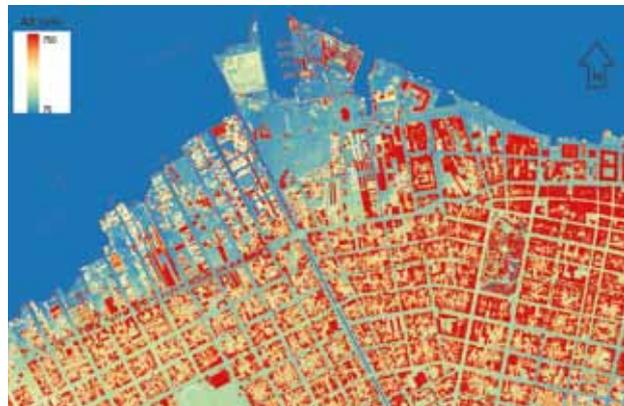
**Figura 9.** Imagem do Modelo Digital de Elevações reduzido ao referencial vertical do SGB, no Centro de Rio Grande.
